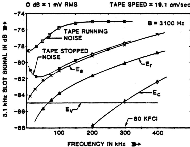
FIG. 38 INDUCTIVE HEAD NOISE SPECTRA
