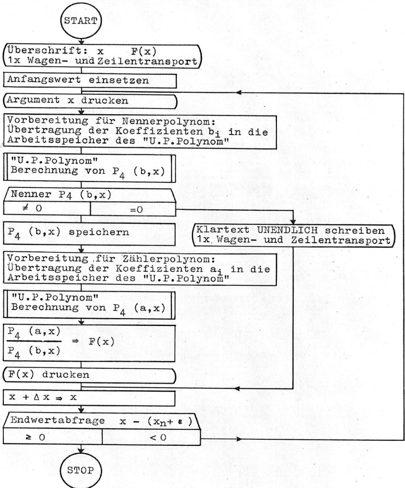
Hier mußte die Abfrage erfolgen, ob der Nenner Null ist, da sonst die Division Bereichsüberschreitung bringt und die Maschine stoppen läßt. Nach dem Ausschreiben von Klartext wird stets einmal Befehl für Wagen- und Zeilentransport gegeben, da Klartext bei der Spaltenzählung nicht mitgezählt wird und somit kein automatischer Übergang auf die nächste Zeile erfolgt (vergl. 3.5 "BUEB" und 3.6.6).
