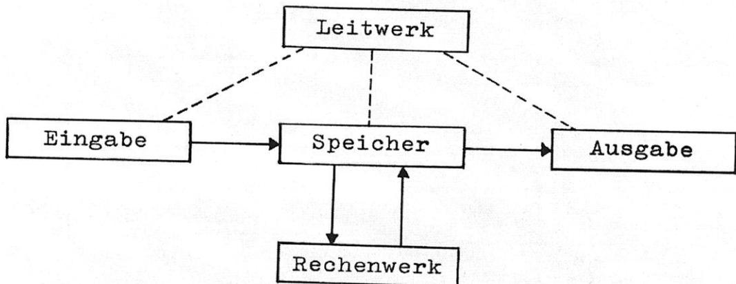
Alle zu verarbeitenden Zahlenwerte sowie alle Programme, d.h. die im Befehlscode der Maschine in logischer Folge niedergeschriebenen Rechenanweisungen, werden der Maschine mittels Lochstreifen eingegeben. Die Lochstreifen werden auf einem gesonderten Programmierungstisch hergestellt.
