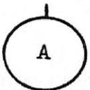
Oft ist es aufgrund der räumlichen Anordnung nicht möglich, die Verbindungslinie zwischen zwei Symbolen (oder die Linien von mehreren Symbolen zu einer bestimmten Stelle) auszuziehen. In solchen Fällen verbindet man den betreffenden Ausgang (oder die betreffenden Ausgänge) mit einem Konnektor, der die gleiche Inschrift trägt, wie ein vor dem Eingang ebenfalls anzubringender Konnektor.
