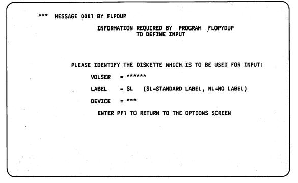
Figure 11-3. FLOPYDUP Input Diskette Definition Screen
