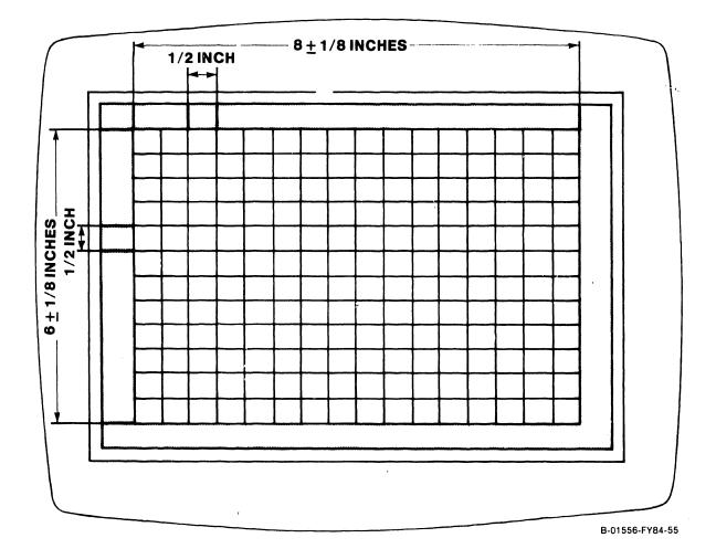
Figure 5-7. VS DTOS Grid Display Pattern
