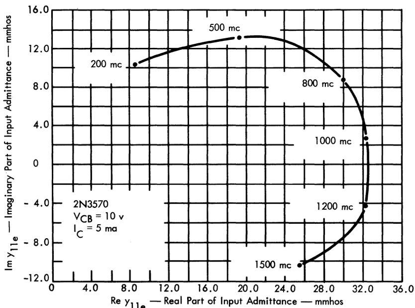
Fig. 8. 2N3570: Im  $y_{11e}$  vs. Re  $y_{11e}$ .
