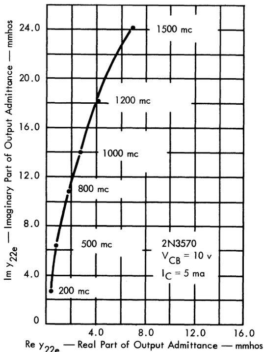
Fig. 7. 2N3570: Im  $y_{22e}$  vs. Re  $y_{22e}$ .
