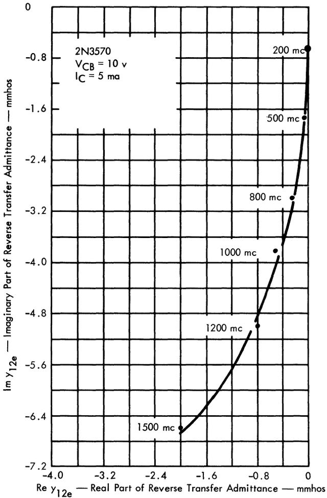
Fig. 2. 2N3570: Im  $y_{12e}$  vs. Re  $y_{12e}$ .
