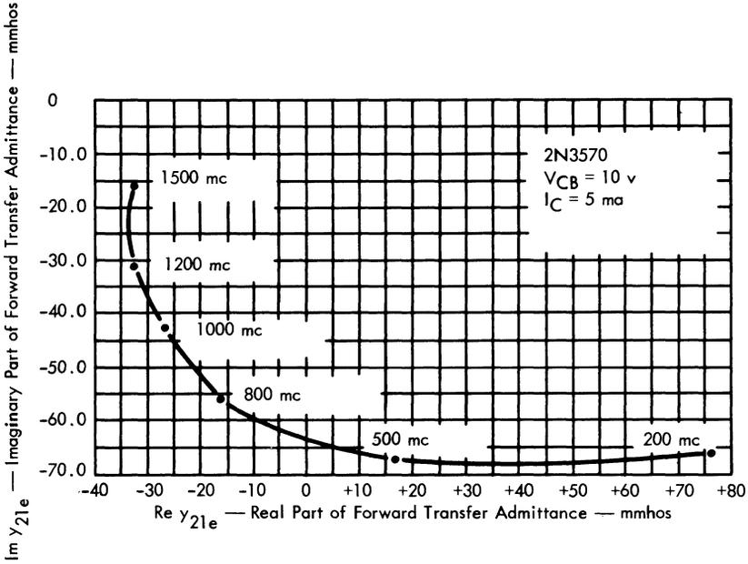
Fig. 3. 2N3570:  $\text{Im } y_{21e}$  vs.  $\text{Re } y_{21e}$ .
