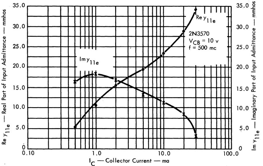
Fig. 6. 2N3570:  $\text{Re } y_{11e}$  and  $\text{Im } y_{11e}$  vs.  $I_C$ .
