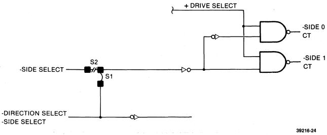
FIGURE 7-6. SIDE SELECTION USING DIRECTION SELECT
