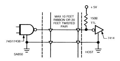
FIGURE 36. INTERFACE SIGNAL DRIVER/RECEIVER
