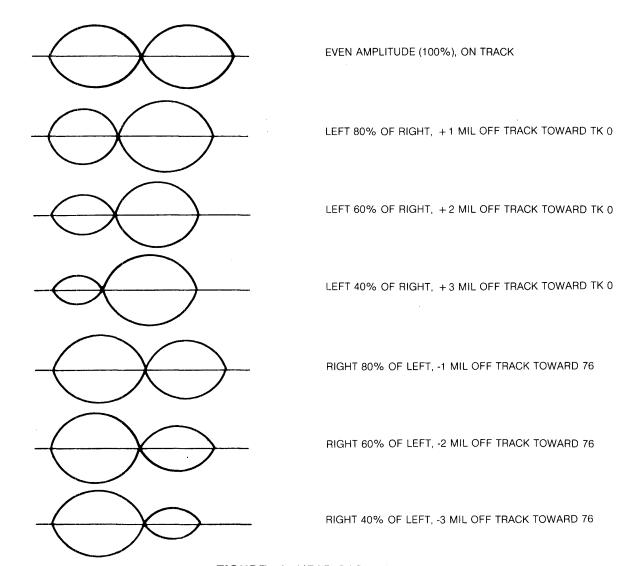
FIGURE 46. HEAD RADIAL ALIGNMENT
