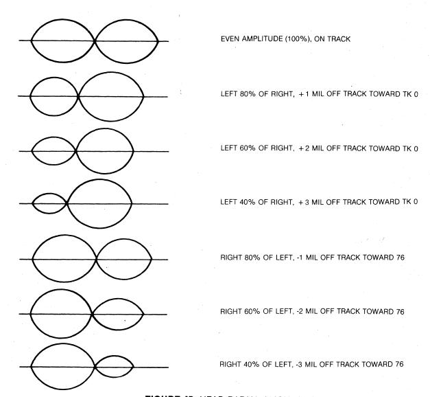
FIGURE 45. HEAD RADIAL ALIGNMENT
