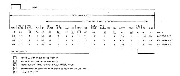
FIGURE 9. MFM TRACK FORMAT COMPARISON
