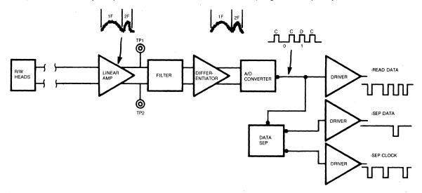
FIGURE 32. READ CIRCUIT FUNCTIONAL DIAGRAM
