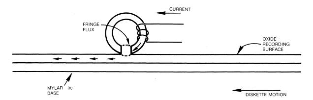
FIGURE 26. BASIC READ/WRITE HEAD
