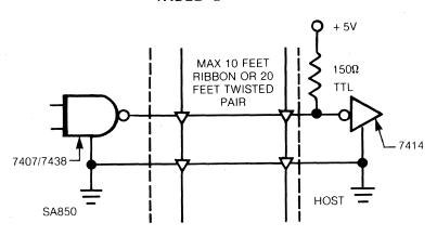
FIGURE 35. INTERFACE SIGNAL DRIVER/RECEIVER
