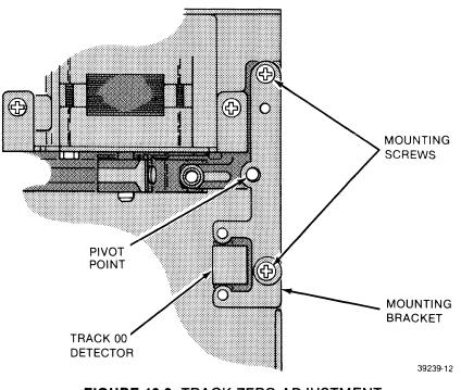
FIGURE 10-9. TRACK ZERO ADJUSTMENT
