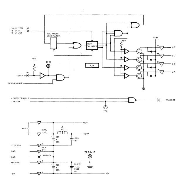
DRIVE PCB STEPPER CONTROLS, TRACK ZERO, POWER
