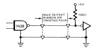
FIGURE 29. INTERFACE SIGNAL DRIVER/RECEIVER
