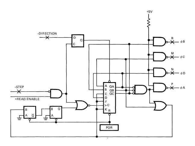
FIGURE 15. STEPPER CONTROL FUNCTION DIAGRAM
