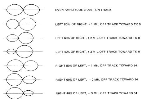
FIGURE 12. HEAD RADIAL ALIGNMENT
