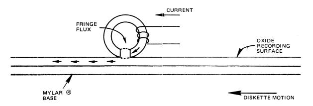
FIGURE 19. BASIC READ/WRITE HEAD
