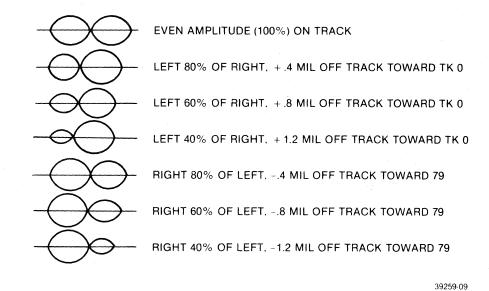
FIGURE 5-8. HEAD RADIAL ALIGNMENT
