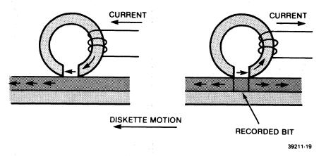
FIGURE 4-3. RECORDING A BIT
