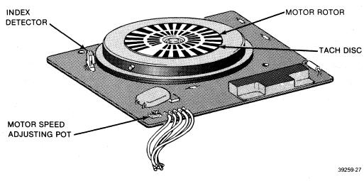
FIGURE 5-10. BRUSHLESS SPINDLE MOTOR ASSEMBLY
