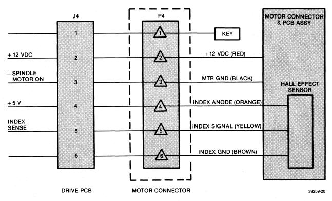
FIGURE 10-2. SPINDLE MOTOR HARNESS CONNECTIONS
