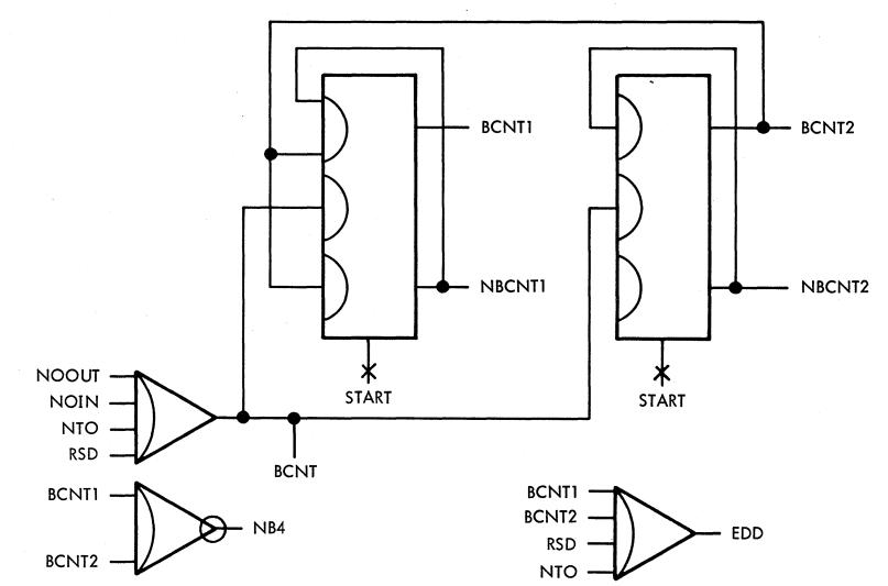
Figure 3–11. Typical Byte Counter
