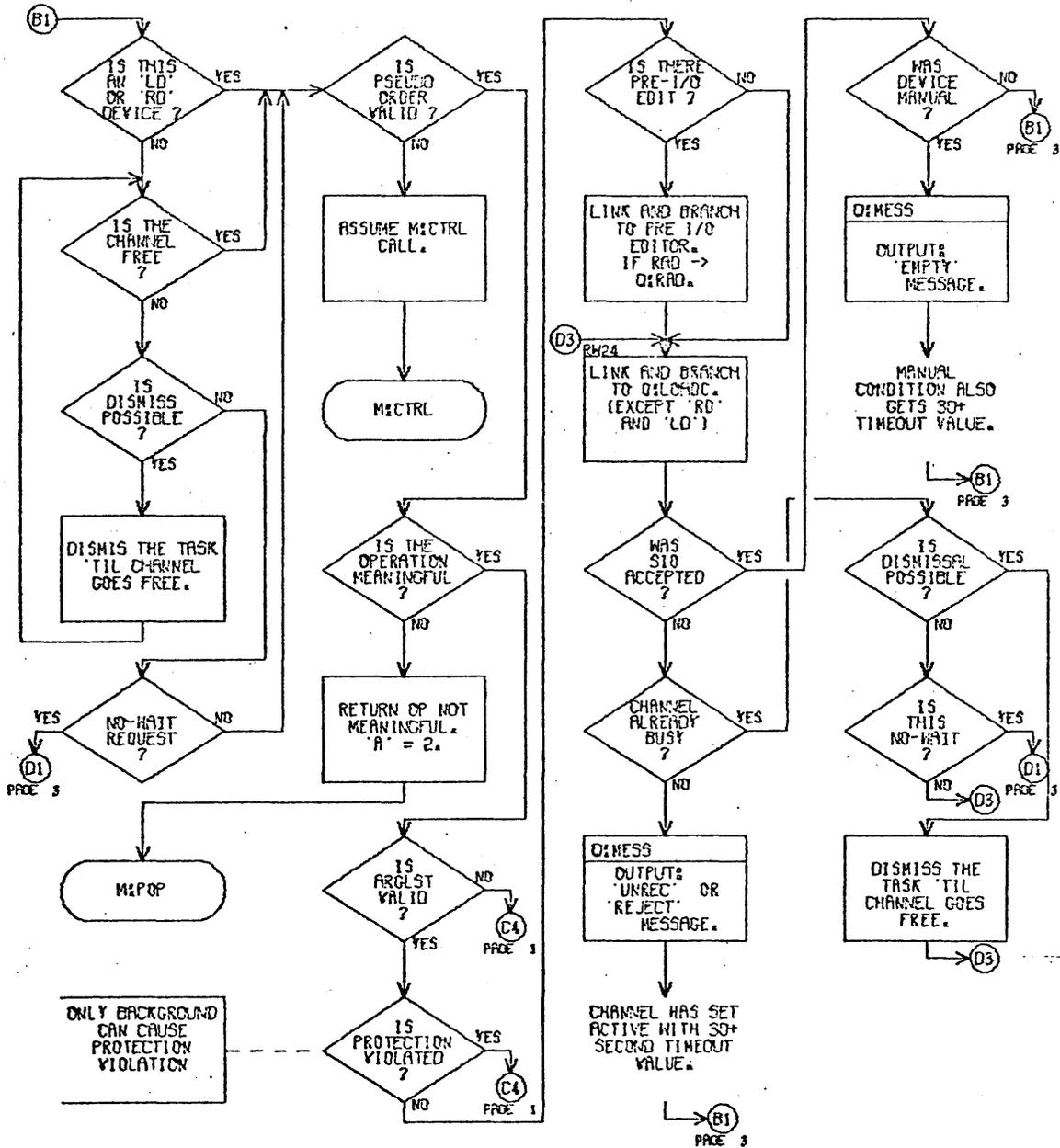
Figure 24. M:READ/M:WRITE Flow (cont.)
