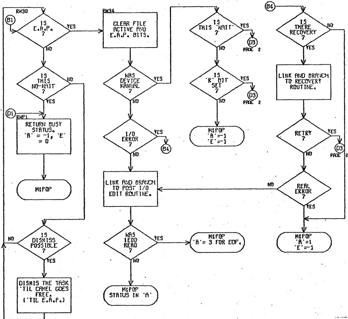
Figure 24. M:READ/M:WRITE Flow (cont.)
