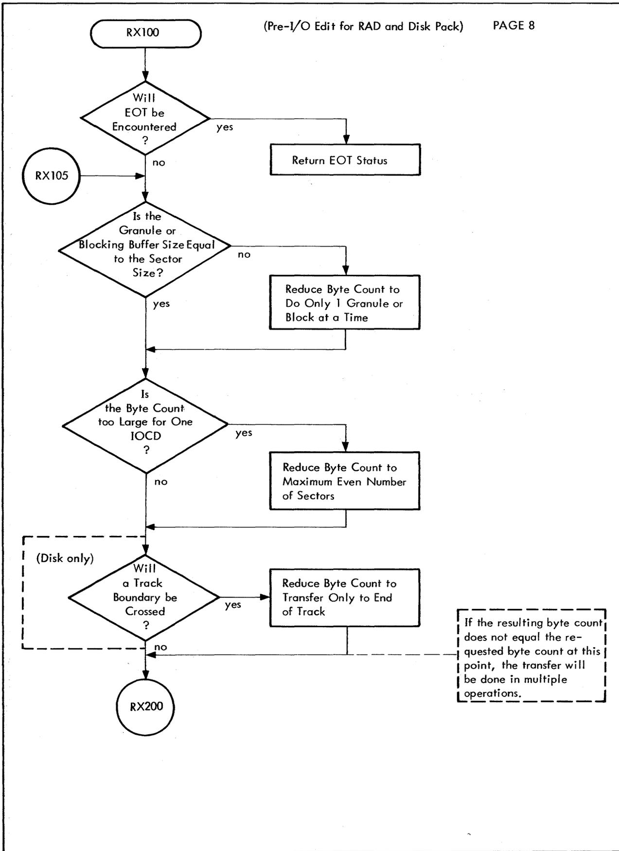
Figure 24. M:READ/M:WRITE Flow (cont.)
