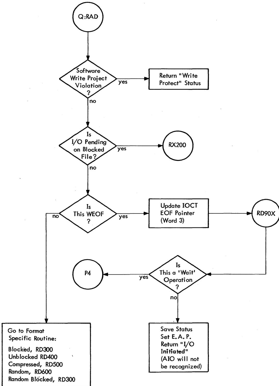
Figure 24. M:READ/M:WRITE Flow (cont.)
