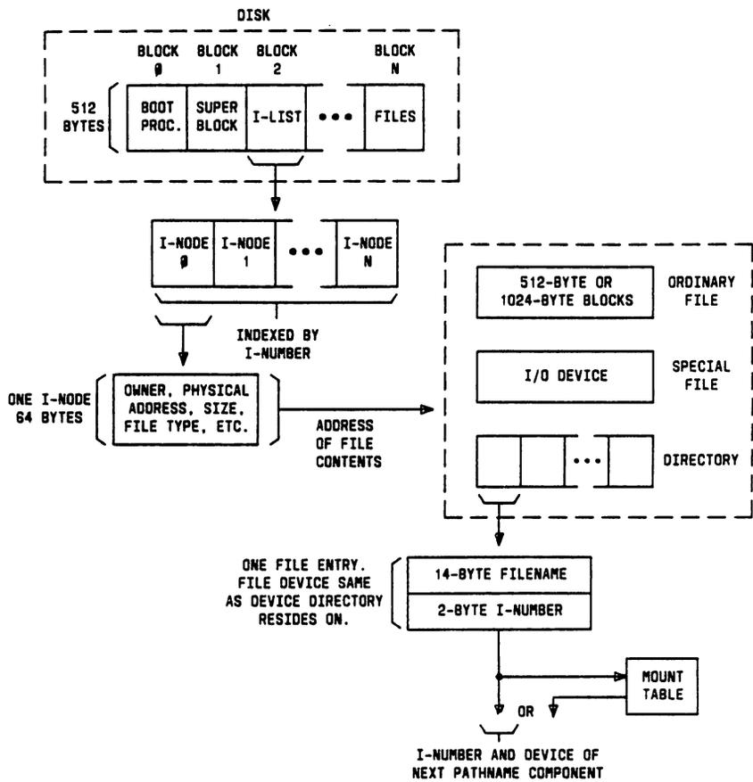
Figure 3-2. I-Node Access Scheme
