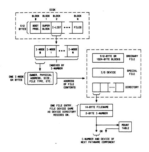
Figure 3-2. I-Node Access Scheme
