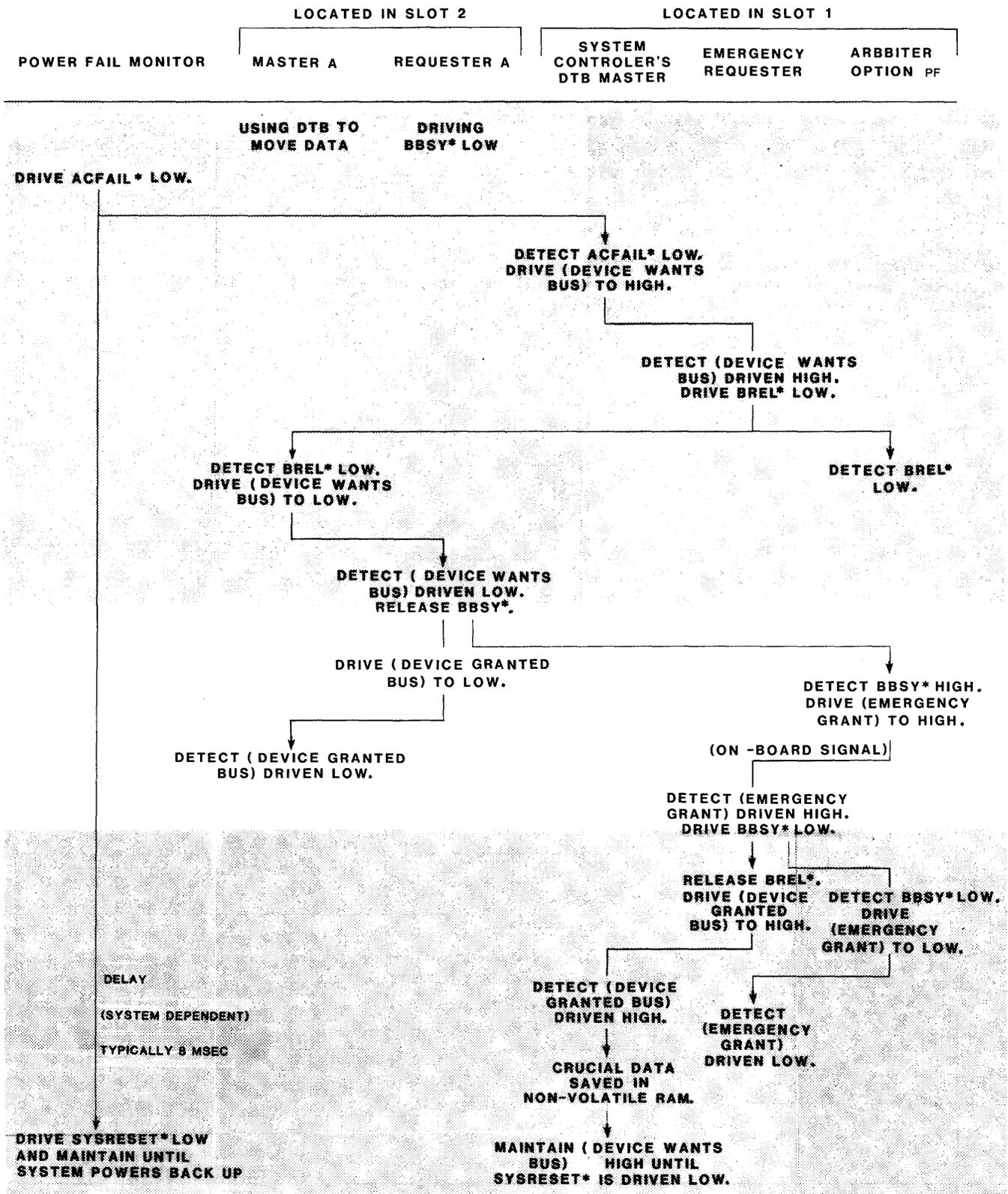
FIGURE 3-11. Power-Down Flow Diagram
