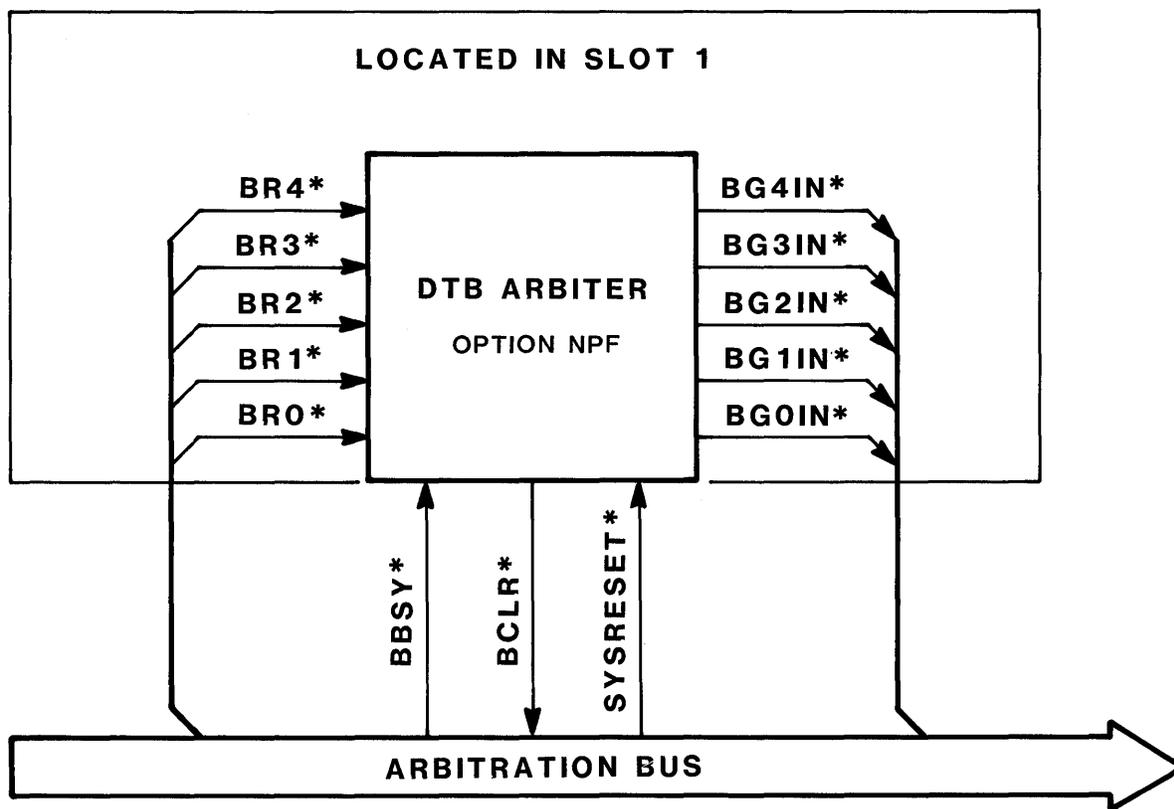
FIGURE 3-3. Block Diagram: Option NPF DTB ARBITER
