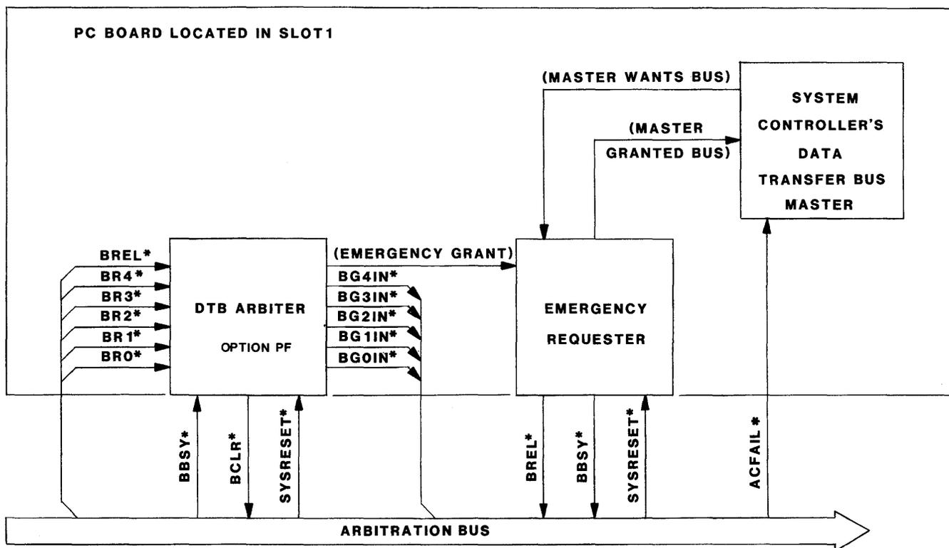
FIGURE 3-4. Block Diagram: Option PF DTB ARBITER
