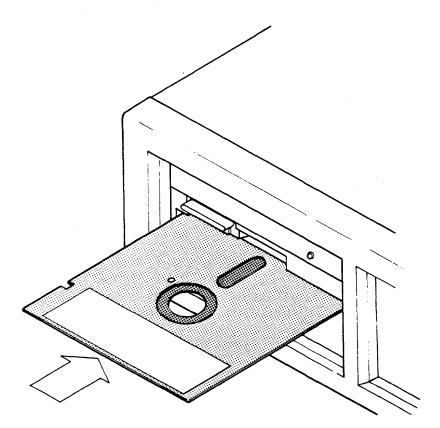
Figure B-3. Inserting the Diskette
