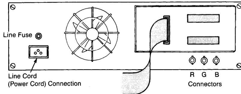
Fig. 10-6. The  $\Omega$ 400 Back Panel
