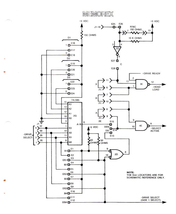
FIGURE 3-6. DRIVE SELECTION (ENCODED) CIRCUITRY
