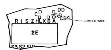
FIGURE 3-8. JUMPER PLUG SHUNT
