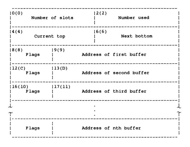
Figure 2-7 IN-QUEUE or OUT-QUEUE Structure
