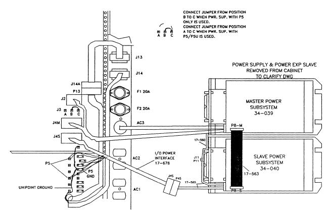
POWER SUPPLY AND SLAVE POWER SUBSYSTEM CABLING
