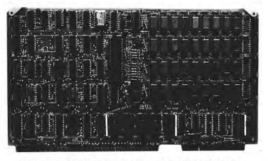
Figure 1-1. iSBC 016A/032A/064A/028A/056A<sup>™</sup> RAM Boards
