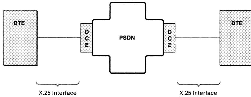
Figure 7. X.25 DTE/DCE Interface
