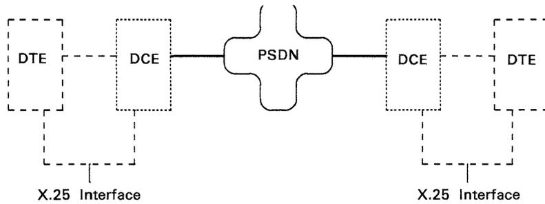
Figure 1-3. The X.25 DTE/DCE Interface
