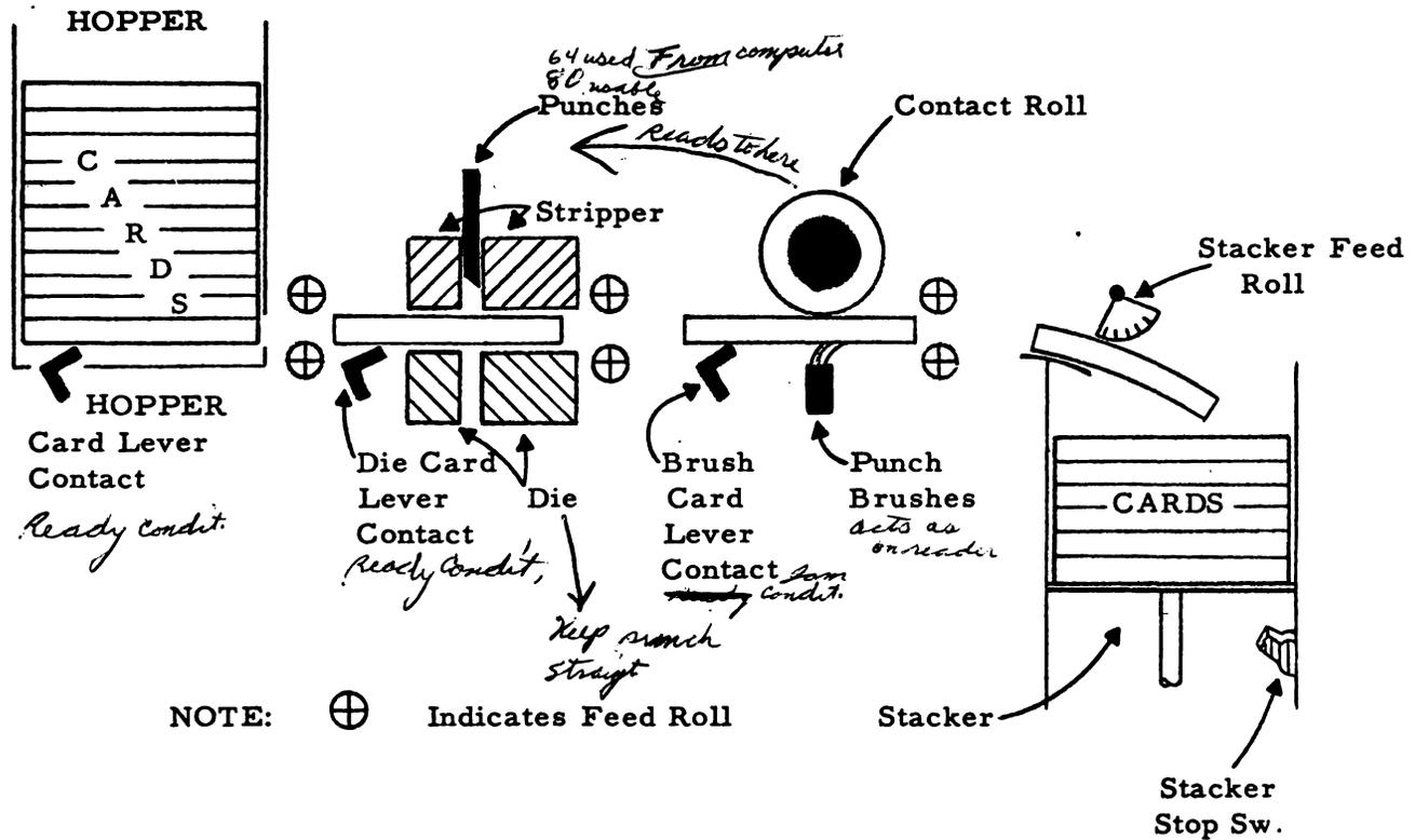
FIGURE 14 - CARD FEED PATH OF CARD RECORDER
