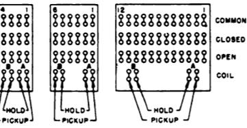
RELAY MOULDINGS (CABLE SIDE VIEW)
