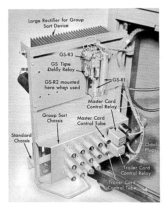
Figure 53. Type 82 Group Sort Relay Gate, 115 volt AC
