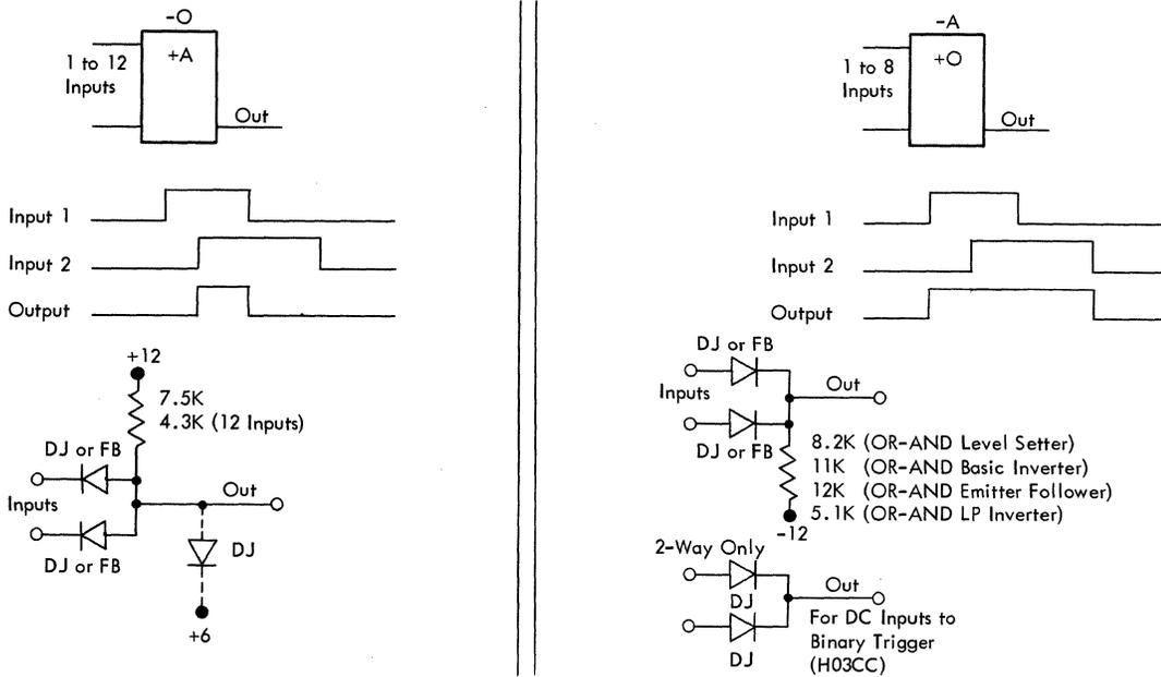
Figure 27. Diode Circuits
