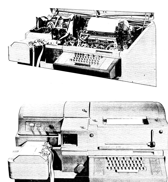
FIGURE 1-25. AUTOMATIC SEND RECEIVE MODEL 28, ASR 28
