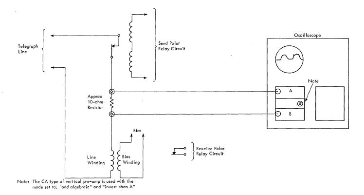
FIGURE 1-37. SCOPING TELEGRAPH CIRCUITS FOR DISTORTION
