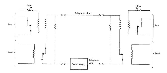
FIGURE 1-26. TELEGRAPHIC LINE CIRCUIT
