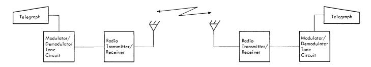
FIGURE 1-5. RADIO TELEGRAPH UTILIZING AUDIO FSK
