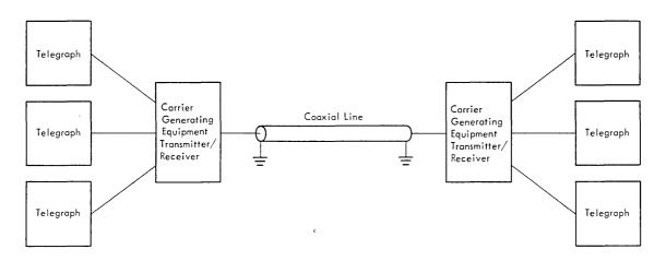
FIGURE 1-4. LINE CARRIER SYSTEM
