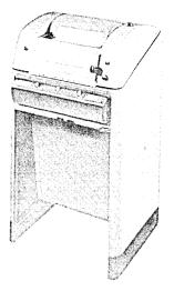
FIGURE 1-18. RECEIVE ONLY PAGE PRINTER (RO)
