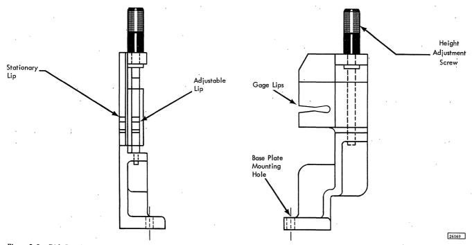
Figure 2-2. Disk Run Out Gage
