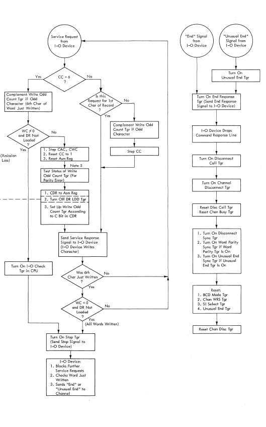
FIGURE 43. WRITE SIMPLEX OPERATION SEQUENCE
