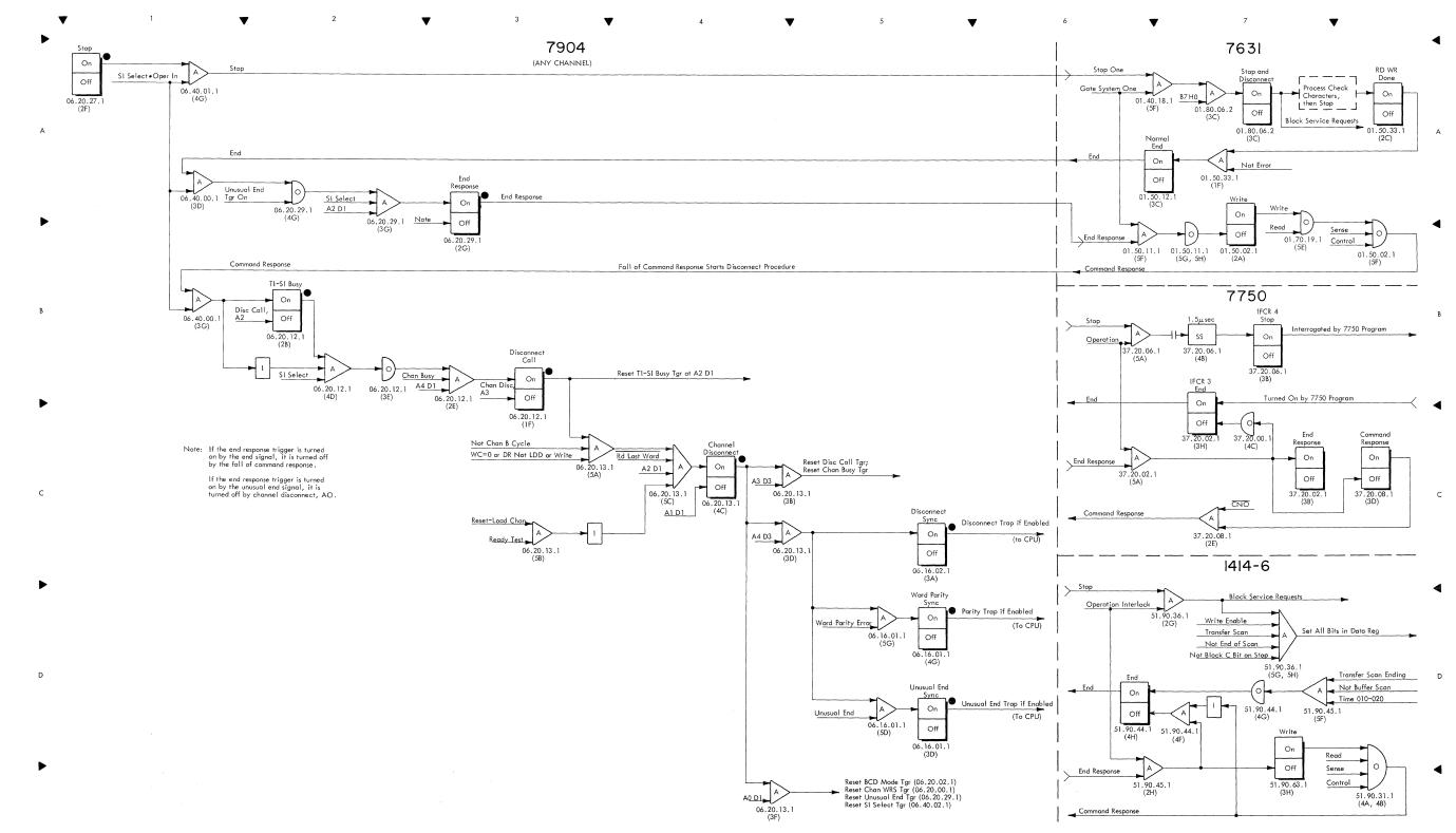
FIGURE 47. END OPERATION AND DISCONNECT, SIMPLEX INTERFACE WRITE OPERATION
