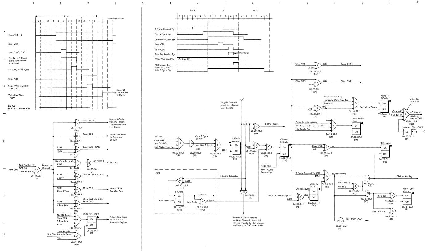
FIGURE 13. RCH, WRITE TAPE OPERATION
