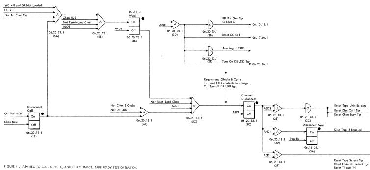
FIGURE 41. ASM REG TO CDR, B CYCLE, AND DISCONNECT, TAPE READY TEST OPERATION
