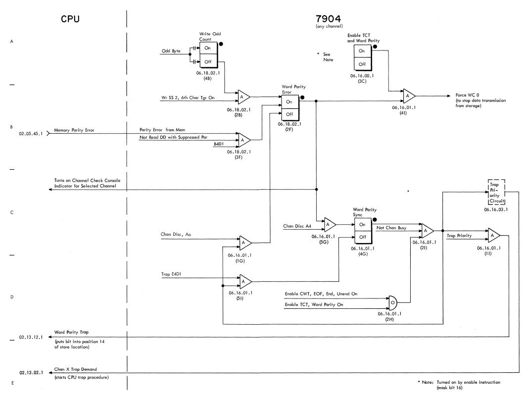
FIGURE 20. WORD PARITY ERROR, WRITE TAPE OPERATION
