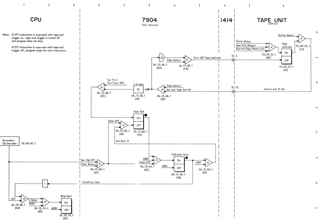
FIGURE 21. ETT, END-OF-TAPE OPERATION
