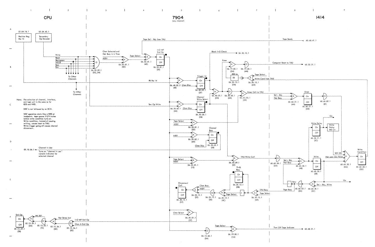
FIGURE 38. WBT, WRITE BLANK TAPE OPERATION
