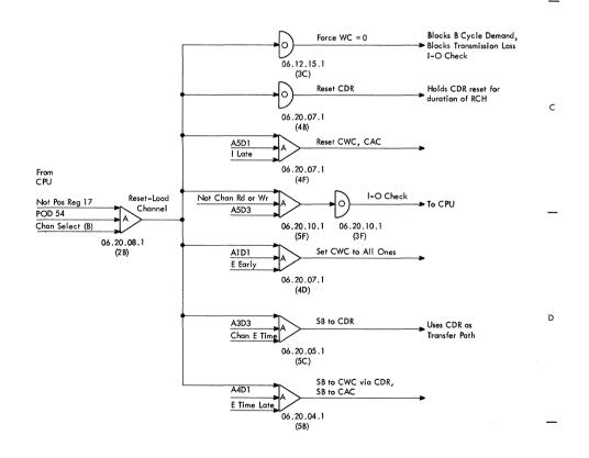
FIGURE 27. RCH, READ TAPE OPERATION
