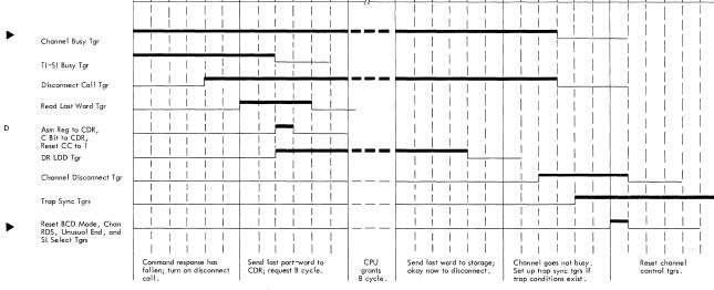
FIGURE 54. END OPERATION AND DISCONNECT, SIMPLEX INTERFACE READ OPERATION
