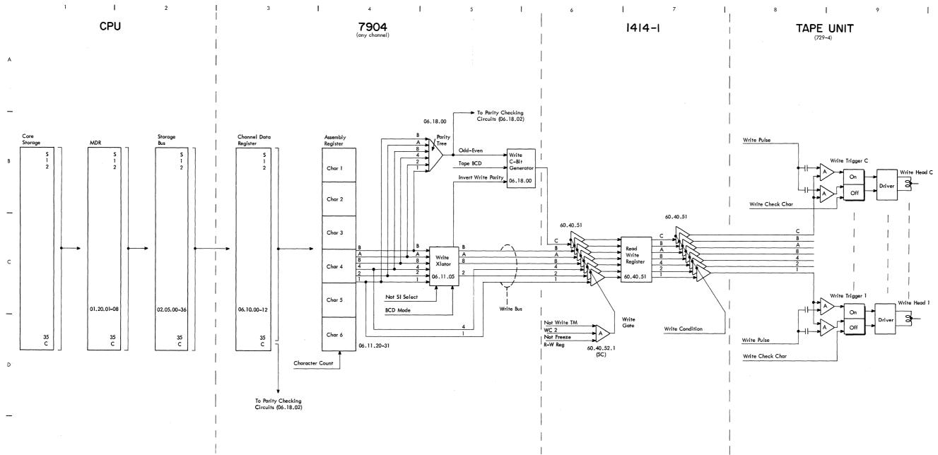
FIGURE 18. DATA FLOW, WRITE TAPE OPERATION
