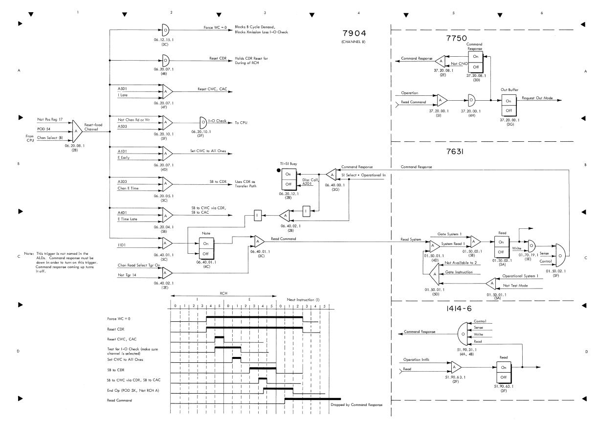
FIGURE 52. RCH, SIMPLEX INTERFACE READ OPERATION
