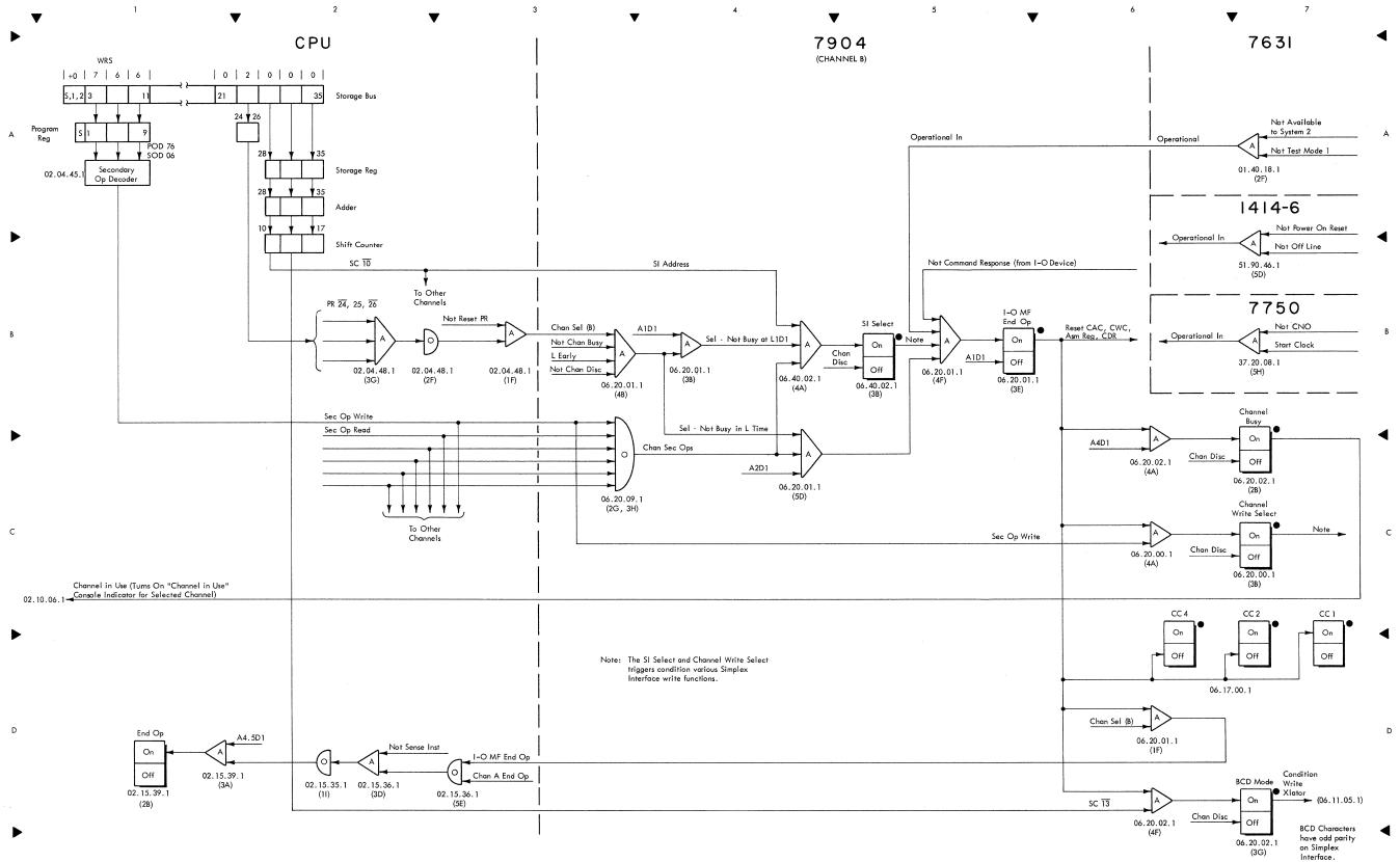
FIGURE 44. WRS, SIMPLEX INTERFACE WRITE OPERATION
