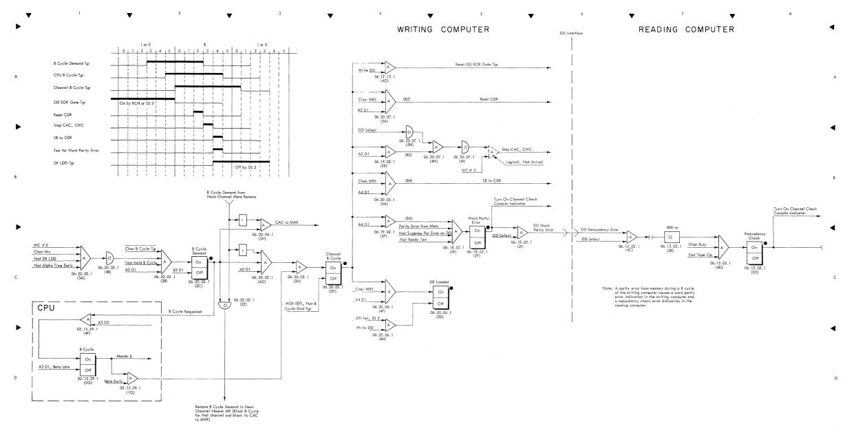
FIGURE 62. B CYCLE, DD WRITE OPERATION
