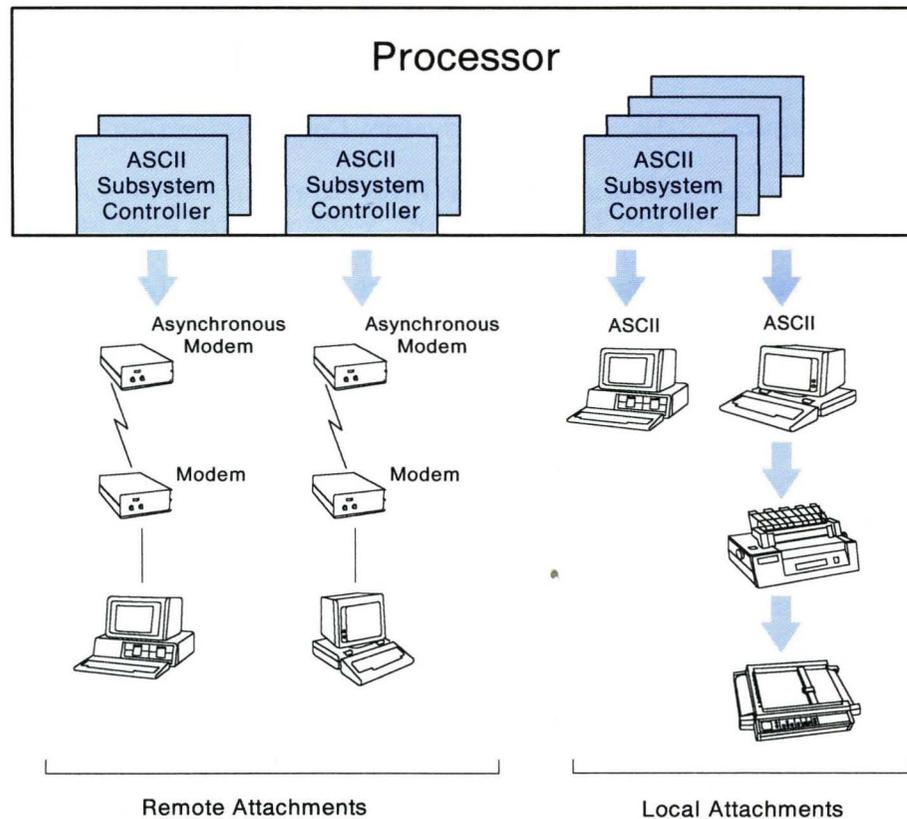
Figure 3-11. ASCII Subsystem
