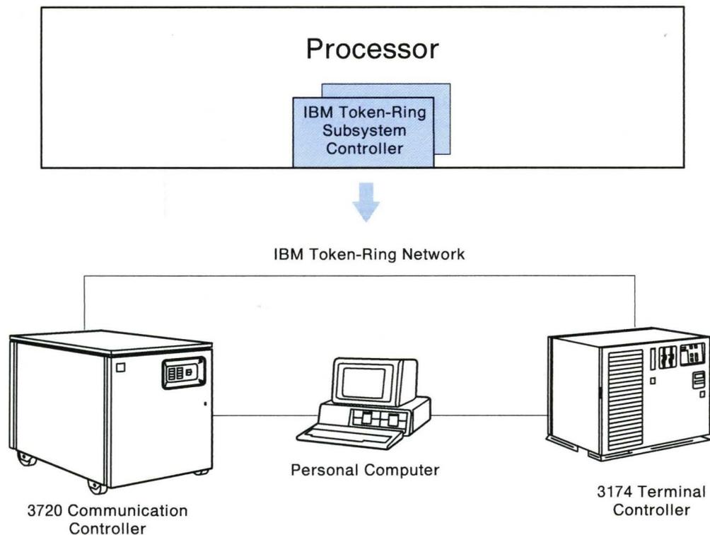
**Figure 3-13. IBM Token-Ring Subsystem**
