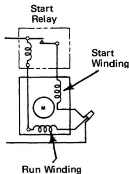
Figure 1-9. Typical Relay-Start Motor
