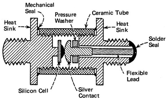
Figure 5-7. Silicon Rectifier-Cross Section
