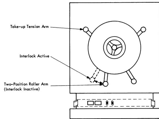
Figure 1018-6. Take-Up Mechanism
