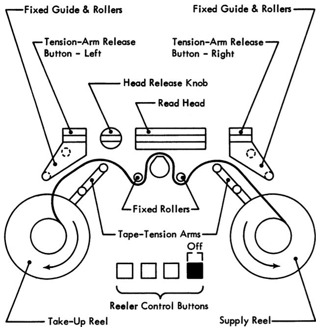
Figure 1017-6. Threading Reeled Tape
