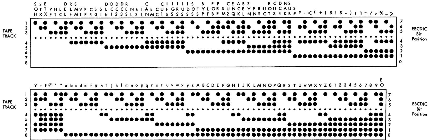
Figure PT-7. USASCII Tape Code
