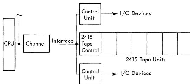
FIGURE 1-1. CONTROL UNIT -- SYSTEM RELATIONSHIP
