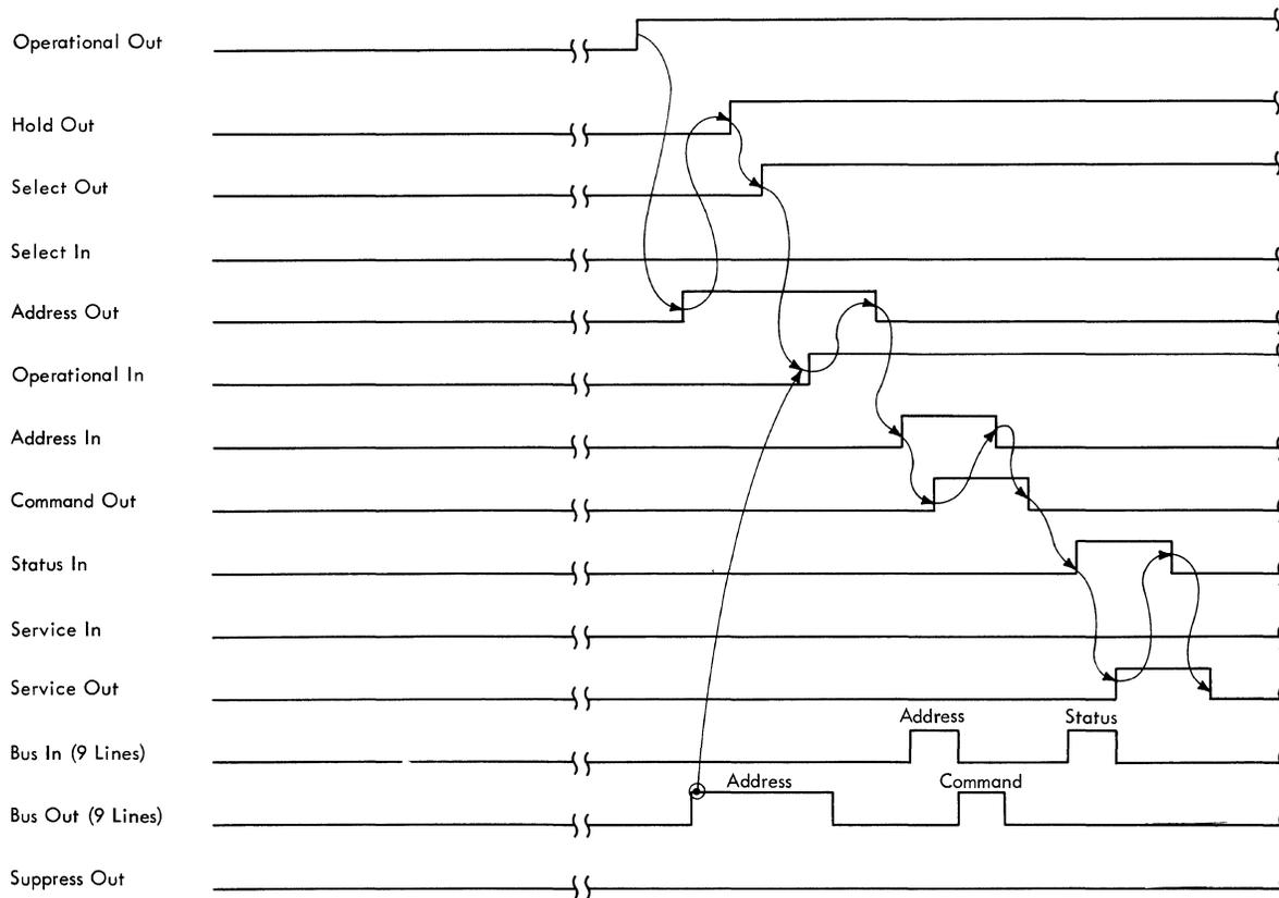
FIGURE 1-11. INITIAL SELECTION INTERFACE SEQUENCE
