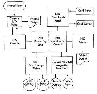
Figure 27. Disk-Storage-Oriented 1460 System Schematic
