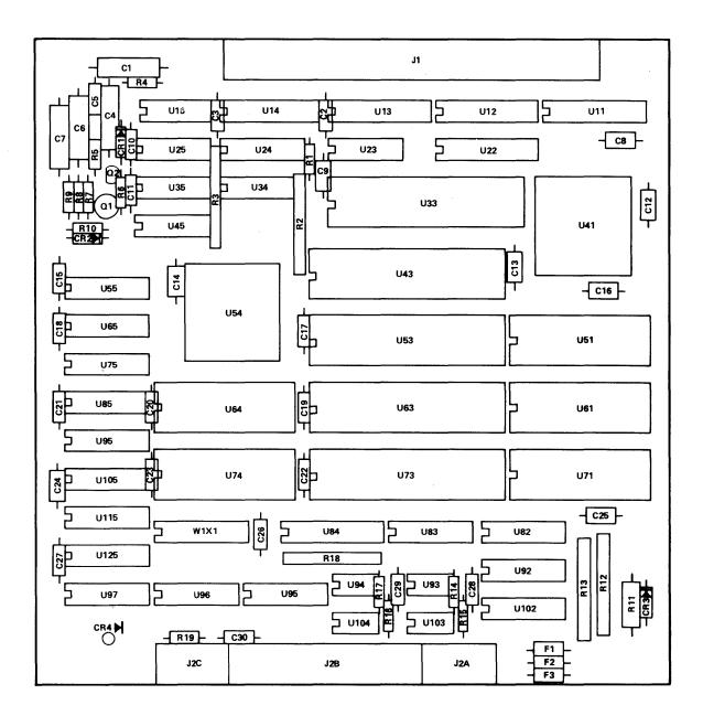
FIGURE 6-1. HP 27130B PARTS LOCATION DIAGRAM
