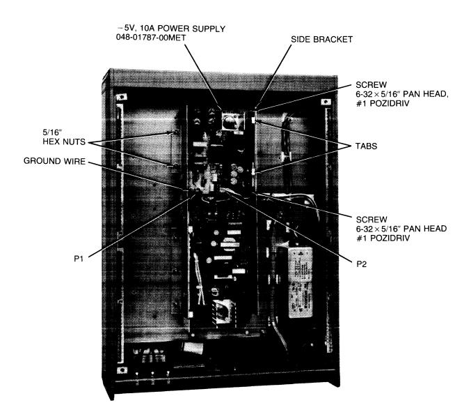
Figure 4-6. - 5V, 10A Power Supply
