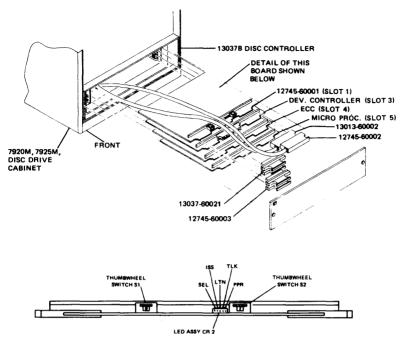
12745A DISC HPIB CONTROLLER BOARD
