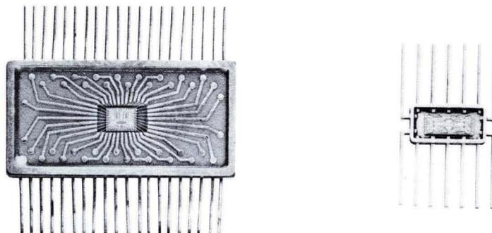
FIGURE 20. A 40 LEAD FLATPACK (LEFT); 14 LEAD FLATPACK (RIGHT).
