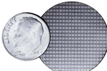
FIGURE 19. MORE THAN 300 CHIPS BEFORE EXTRACTION.
