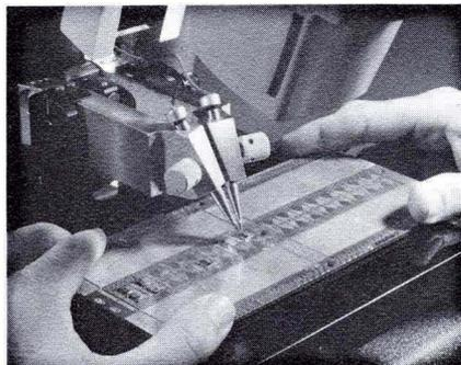
FIGURE 30. FLATPACK BEING WELDED TO MEMORY PLANE.
