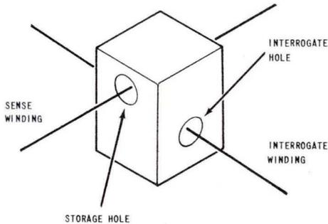
FIGURE 10. THE BIAX ELEMENT SHOWING HOLE LOCATION.
