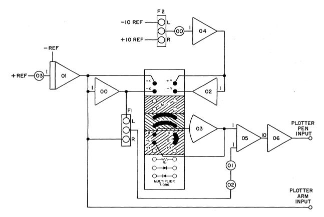
a. TEST SETUP SHOWING MULTIPLIER PATCH BLOCK
