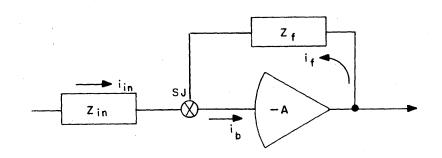
FIGURE 2.1-3. OPERATIONAL AMPLIFIER, BLOCK DIAGRAM
