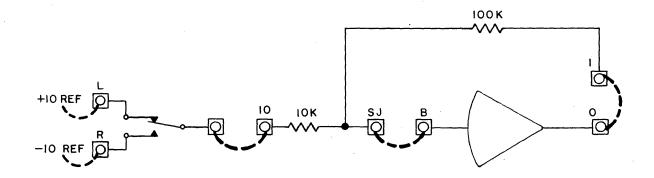
FIGURE 2.1-9. AMPLIFIER STABILIZER TEST SETUP
