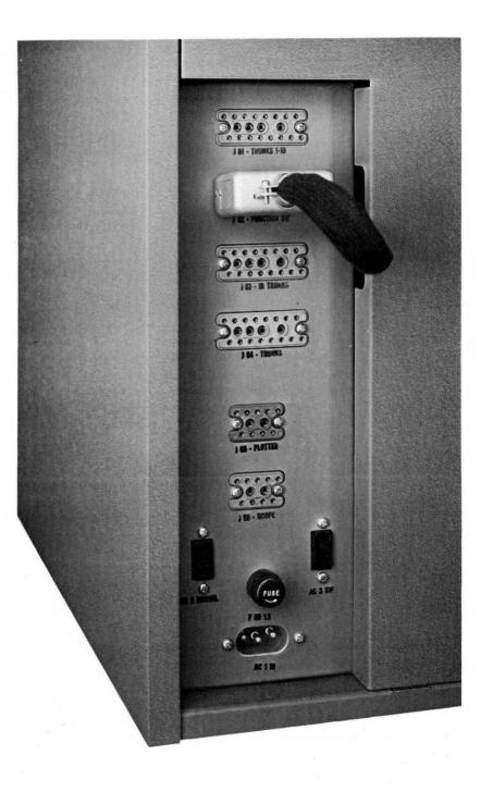
FIGURE 1.5-1 PLUG PLATE, REAR TR-48
