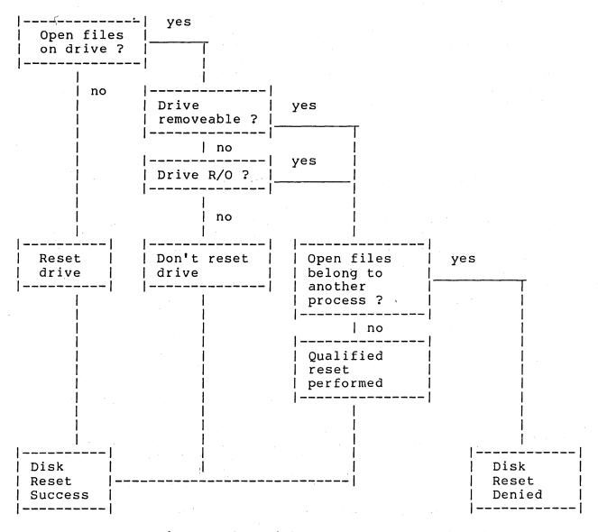
Figure 2-1. Disk System Reset
