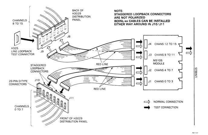
Figure 1-3 DHU11 Connections
