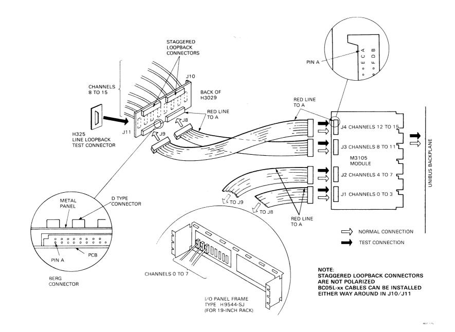
Figure 2-2 DHU11 Installation
