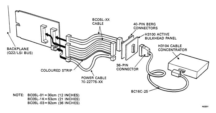
Figure 1-4 DHQ11 Connections (DEC423)
