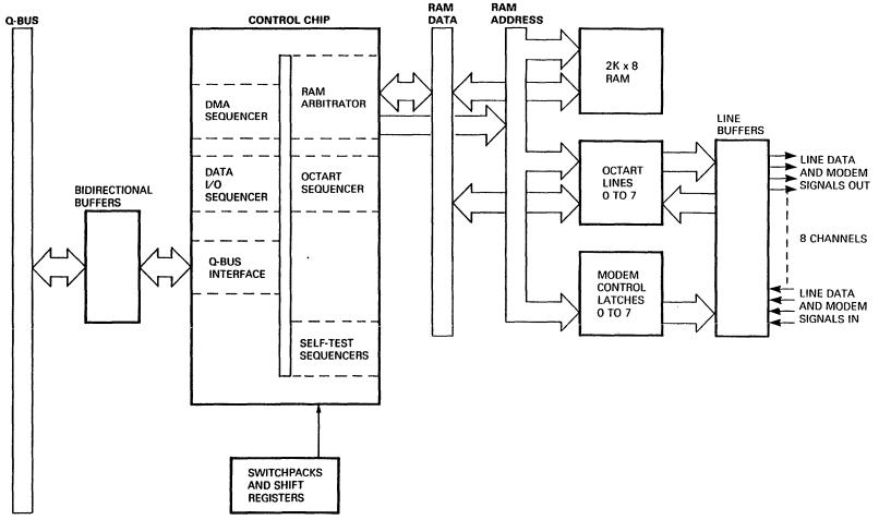
Figure 1-5 DHQ11 Functional Block Diagram
