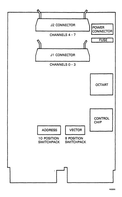
Figure 1-1 Layout of the DHQ11 Module
