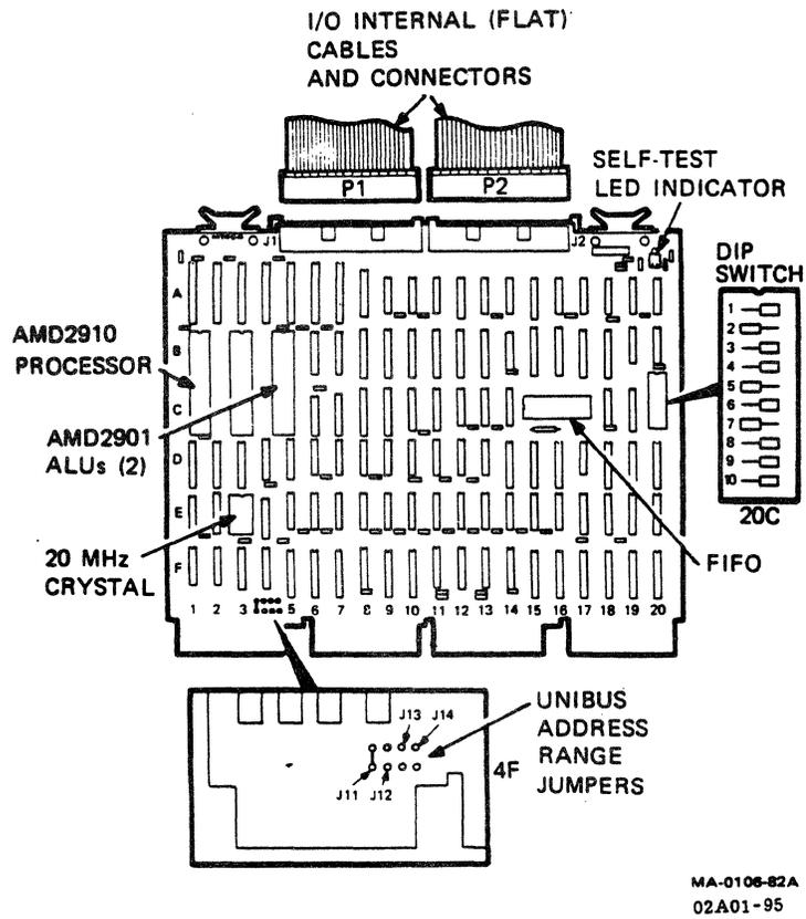
Figure A-2. M7454 UNIBUS ADAPTER MODULE
