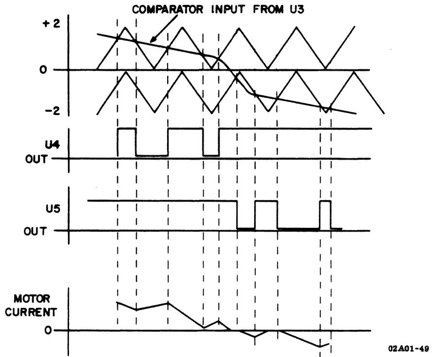
Figure 4-27. POWER AMPLIFIER WAVEFORMS
