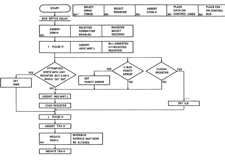
\* RH INDICATES THAT THE OPERATION IS PERFORMED BY THE MASSBUS CONTROLLER
