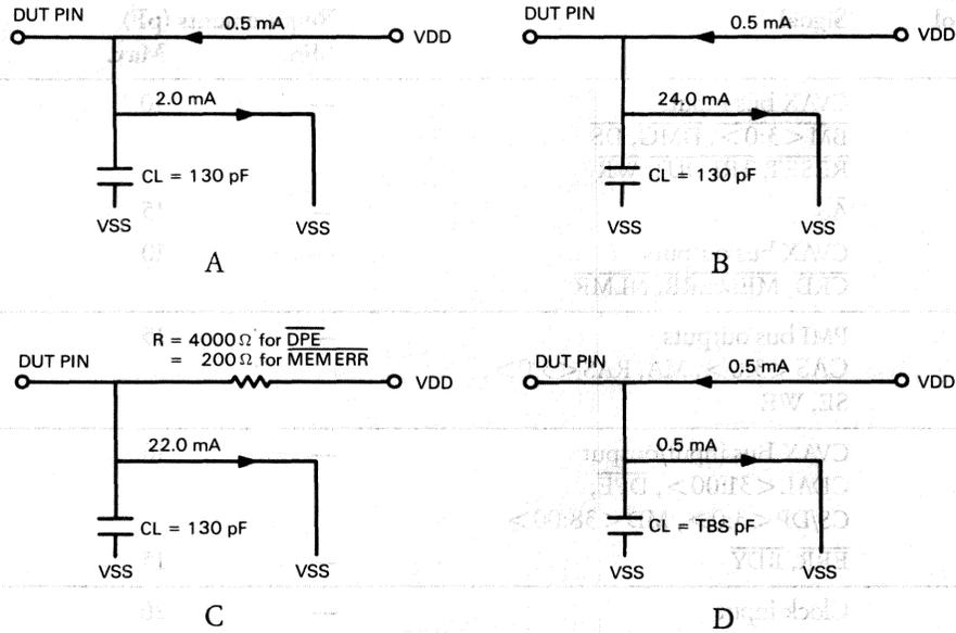
Figure 10 • CVAX 78588 ac Test Circuits
