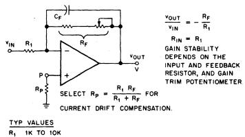
THE USE OF CF REDUCES THE TENDENCY OF THE OP AMP TO OSCILLATE
