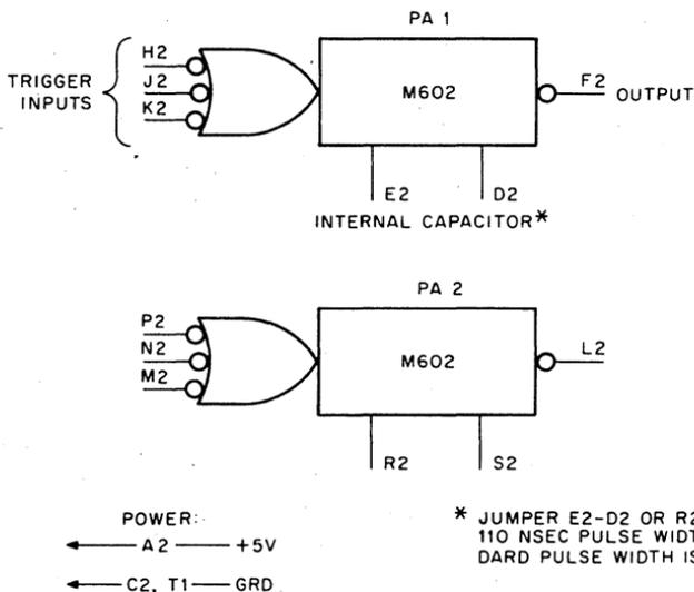
\* JUMPER E2-D2 OR R2-S2 FOR 110 NSEC PULSE WIDTH. STANDARD PULSE WIDTH IS 50 NSEC.
