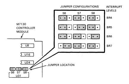
NOTE: CONFIGURATION SHOWN (INTERRUPT LEVEL BR5) IS THE USUAL FACTORY SETTING
